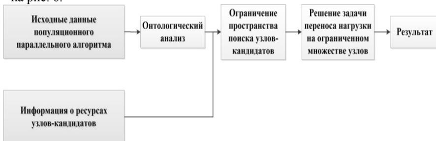
Рис. 6. Концепция метода формирования ограничений в задаче переноса вычислительной нагрузки
